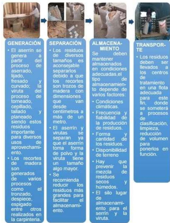
Fig. 2. Residuo de madera a través de sus fases
